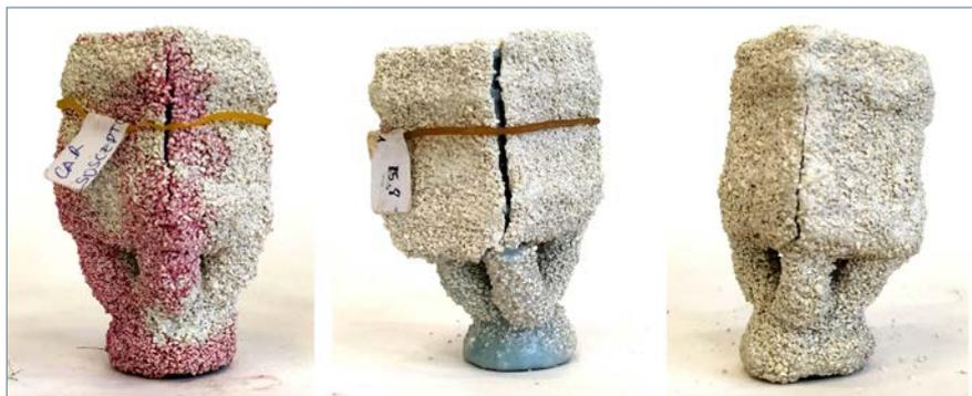
Figura 5. Moldes de cascarilla cerámica de la muestra CA. Ceras roja, azul y marrón de izquierda a derecha.
