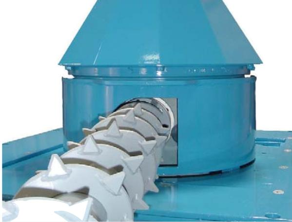
Construcción sólida para recoger densidades de carga extremas durante la extracción desde silos altos. Tiene aplicación especialmente para virutas y silos de mayor diámetro.
