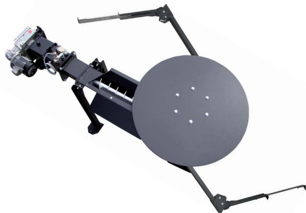
Para descargar la madera troceada del silo con un diámetro máximo de trabajo de 6,0 metros.
