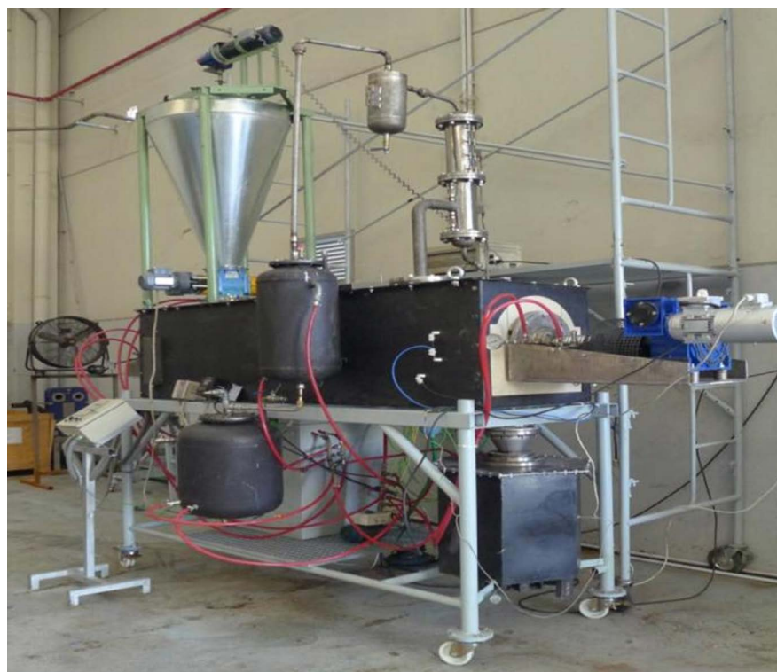
Figura 4. Prototipo del equipo modular de pirólisis empleado. Imagen tomada por GOES.
