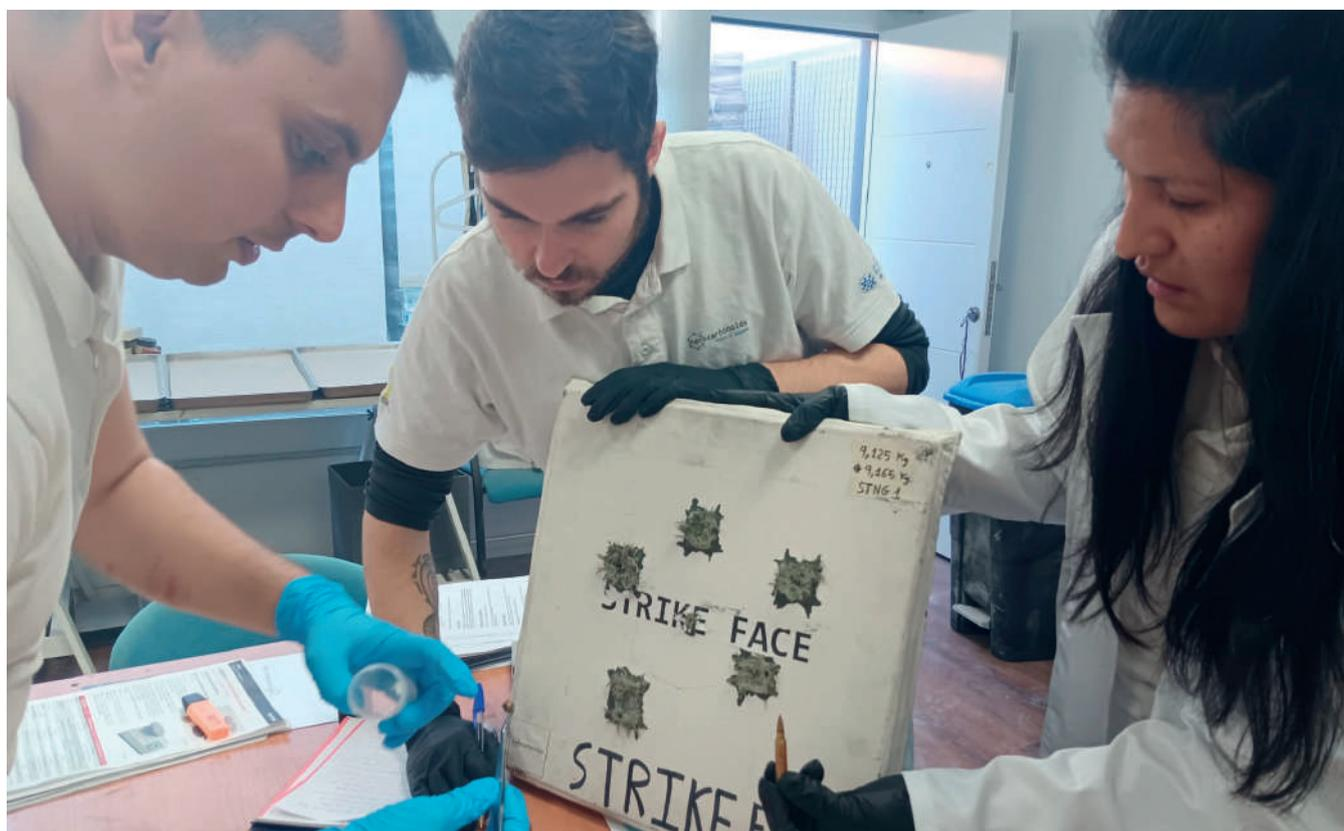
El equipo de ingenieros de Nanocarbonoids analiza una de las placas certificadas según estándar OTAN, una vez ensayadas.
